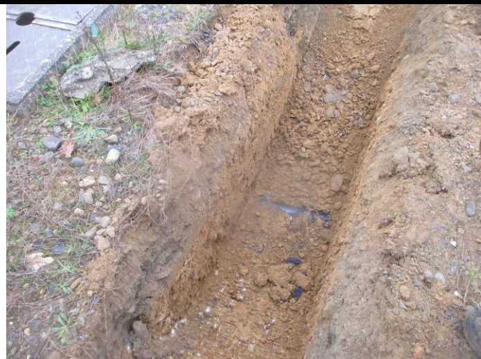
Sondage A13 : P010 brai canalisation
