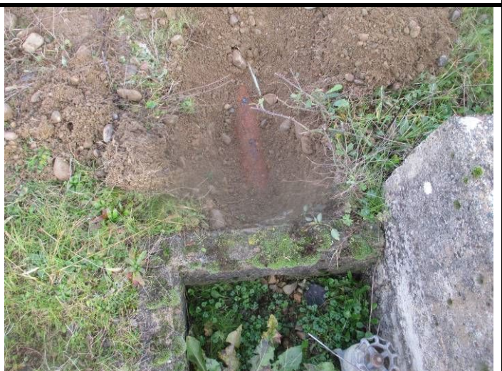
Sondage A17 : P014 brai canalisation
